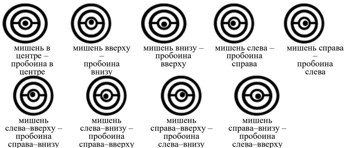
Рисунок 16 – Варианты расположения мишени внутри кольцевой мушки и направления отклонений пробоин от центра
