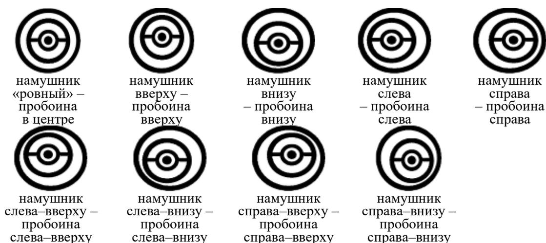
Рисунок 15 – Варианты расположения намушника с кольцевой мушкой внутри диоптра и направления отклонений пробойн от центра
